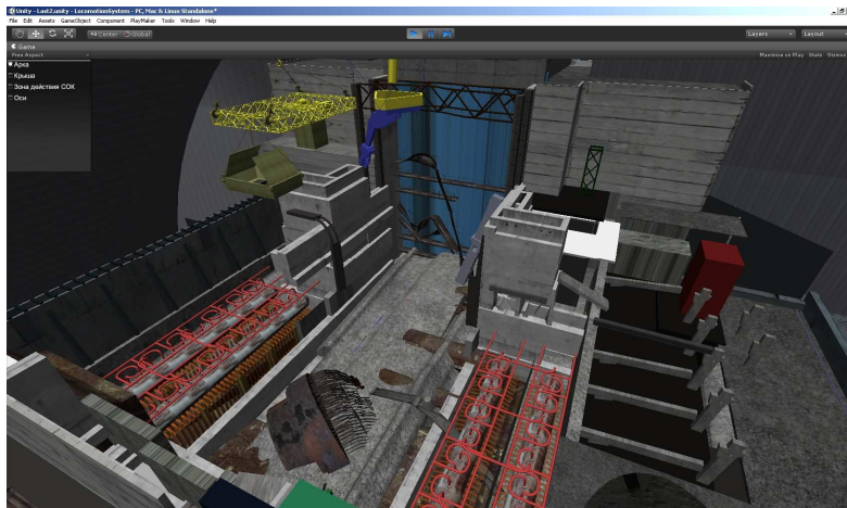
Рис. 4. Вигляд ЦЗ після демонтажу перекриття приміщень південних та північних барабан-сепараторів.
