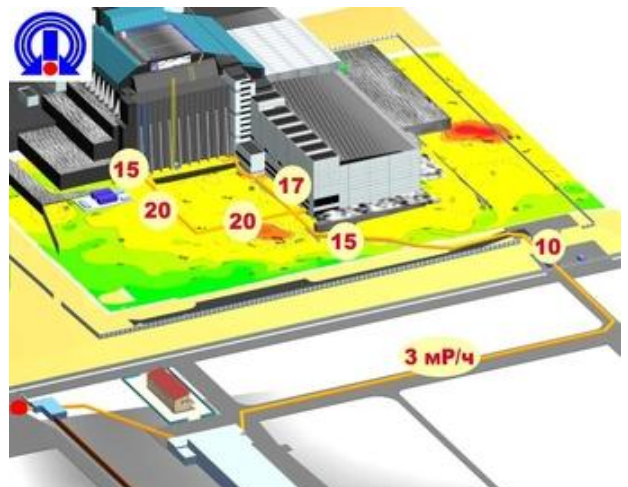
Рис. 2. Маршрут доступу на промисловому майданчику об'єкта "Укриття" із зазначенням потужності експозиційної дози (ПЕД).
