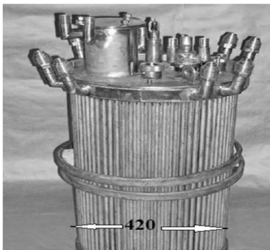
Рис. 3. Розмір і характеристики холодного тигля. Основний матеріал – сталь 12X18Н10Т4; маса \approx 300 кг; витрата води на охолодження – 10 м 3 /год.
