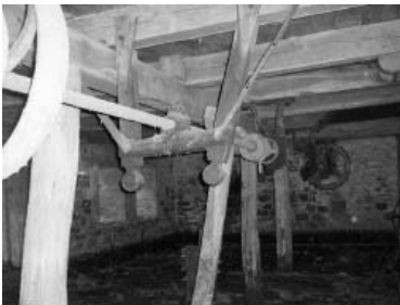
Рис. 4. Основний вал, що передавав рух від водяного колеса до мукомельних машин і механізмів. Цокольний (напівпідвальний) поверх млина у селі Карабіїв Ружинського р-ну Житомирської обл., р. Роставиця.
