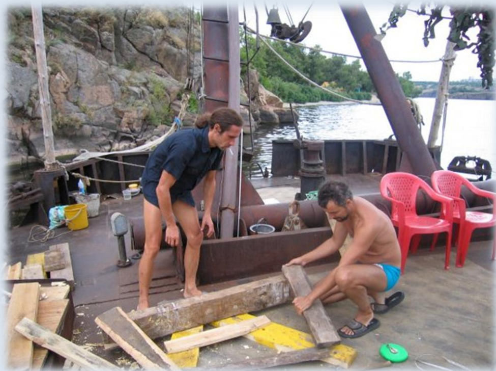
Фото 22. Изготовление элементов конструкции для подъема кормы судна.
