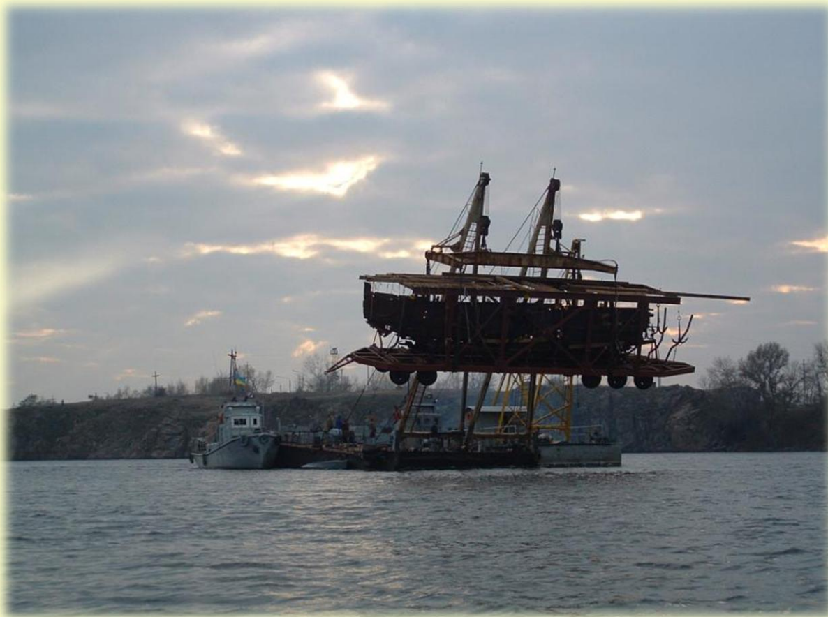
Фото 13. Транспортування стапелю з бригантиною через Дніпро.
