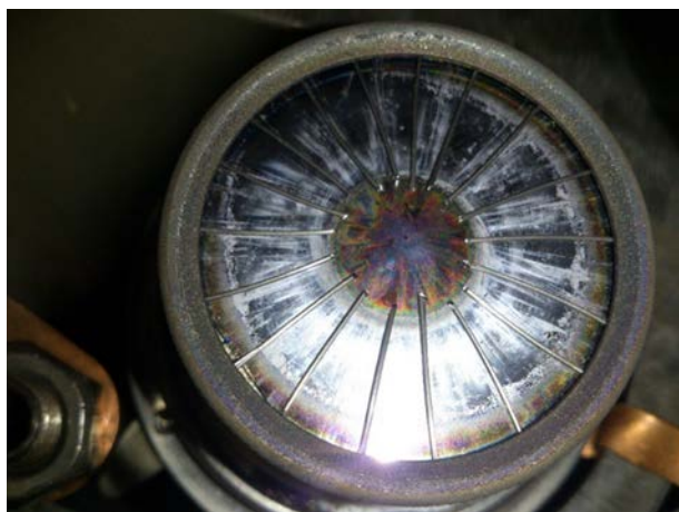
Рис. 1. (Онлайн в цвете). Фотография составной мишени Si+W для осаждения барьерного слоя. На пластине кремния расположены проволочки вольфрама.
