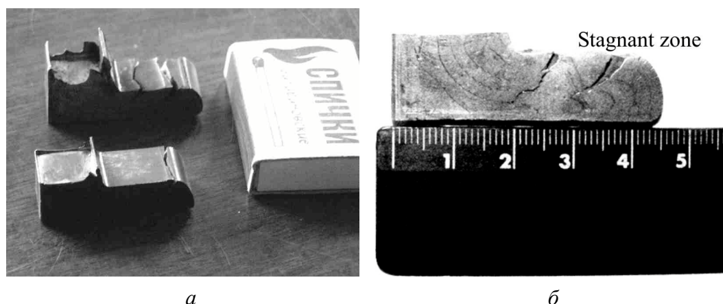
Рис. 2. Внешний вид деформированных заготовок (а) и координатной сетки на продольном сечении заготовки (б) после РКУ-прессования
