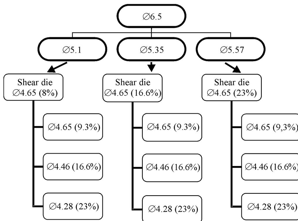
Рис. 1. Схема волочения (в процентах приведены разовые обжаты)
