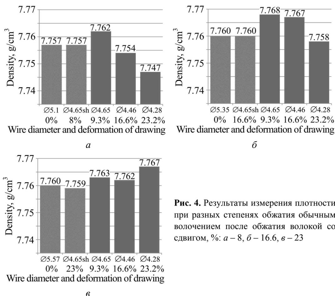
Рис. 4. Результаты измерения плотности при разных степенях обжатия обычным волочением после обжатия волокой со сдвигом, %: а – 8, б – 16.6, в – 23
