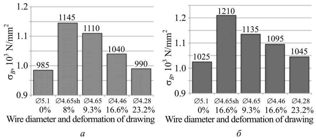
Рис. 3. Предел прочности проволоки при разных степенях обжатия обычным волочением после обжатия волокой со сдвигом, %: а – 8, б – 16.6, в – 23
