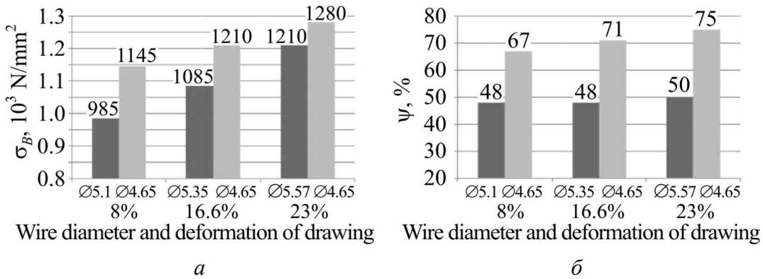
Рис. 2. Механические свойства проволоки при разных степенях обжатия при переходе с круглой волоки ( $\varnothing 5.1, 5.35, 5.57$ ) на волоку со сдвигом ( $\varnothing 4.65$ ): а – предел прочности, б – относительное сужение
