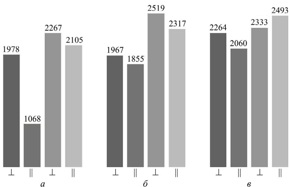
**Рис. 5.** Микротвердость проволоки в поперечном ( $\perp$ ) и продольном ( $\parallel$ ) сечениях при переходе с круглой волоки ( $\varnothing 5.1, 5.35, 5.57$ ) на волоку со сдвигом ( $\varnothing 4.65$ ) при разных степенях обжатия волокой со сдвигом, %: *a* – 8, *б* – 16.6, *в* – 23
