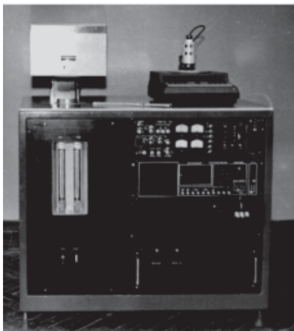
Рис. 22. Экспериментальная технологическая установка для ПХТ и РИПТ «Контур-02», оснащенная реактором на основе ВЧ индукционного плазменного конденсатора.
