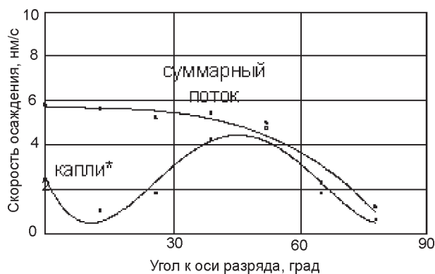
Рис. 3. Угловые распределения частиц, генерируемых вакуумной дугой с молибденовым катодом; (*для капле масштаб по оси Y увеличен в 100 раз); ввиду малого содержания капле, суммарный и атомарный потоки практически совпадают.
