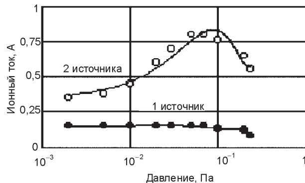
Рис. 19. Зависимости ионного выходного тока на цилиндрический подложкодержатель от давления азота. Ток дугового разряда 85 А.
