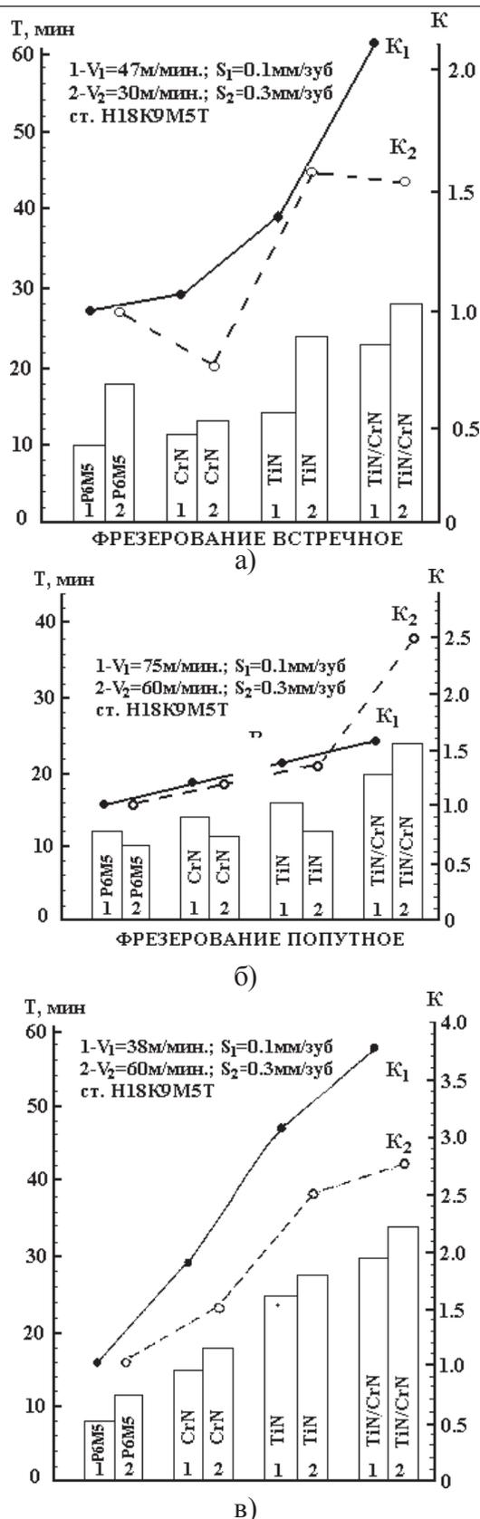
Рис.5. Влияние режимов торцевого фрезерования на стойкость ( $T$ ) и относительный коэффициент увеличения стойкости ( $K$ ) пластин из Р6М5 с монослойными  $\text{TiN}_x$ ,  $\text{CrN}_x$  и нанослойными  $\text{TiN}_x/\text{CrN}_x$  покрытиями при обработке стали Н18К9М5Т и ст. 45. Виды фрезерования: а) – встречное, б) – попутное и в) – симметричное
