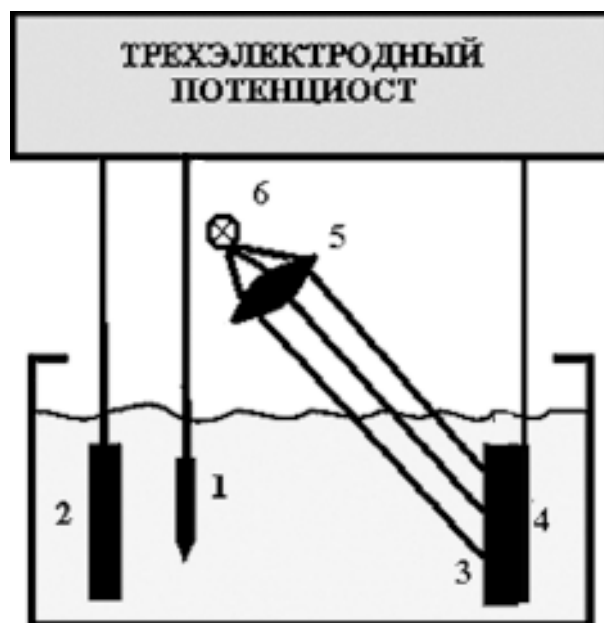
Рис. 1. Установка для фотоэлектрохимического травления p -InP (1 – контрольный электрод, 2 – катод, 3 – пластина монокристаллического InP, 4 – омический контакт, 5 – собирающая линза, 6 – вольфрамовая лампа мощностью 200 Вт).
