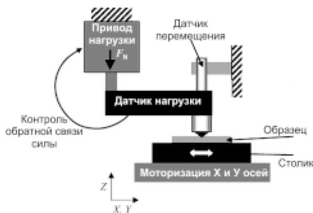
Рис. 1. Схема скретч-тестера REVETEST.
