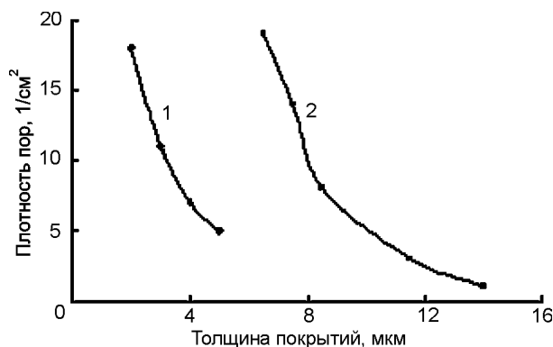
Рис. 5. Зависимость плотности сквозных пор от толщины покрытий TiN, осажденных с помощью газового источника (1) и вакуумно-дуговым методом (2).
