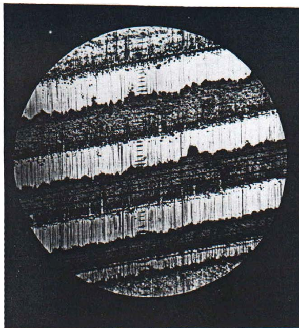
Рис. 1. Фотография микроструктуры многослойного покрытия, полученного методом КИБ: чередующиеся мягкие слои Mo (темные слои) и твердые слои \text{Mo}_2\text{N} (светлые). Увеличение: \times 700
