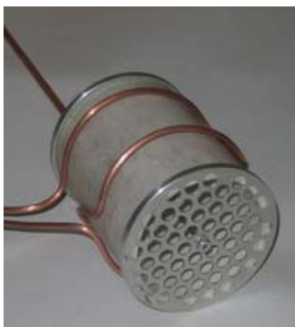
Рис. 4. Схема та фото джерела ВЧІ плазми
