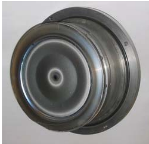
Рис. 2. Схема та фото магнетрона на постійних магнітах
