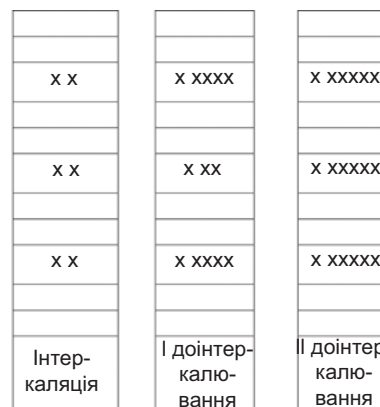
Рис. 10. Схематичне зображення можливого розташування \beta -CD в розширеній матриці селеніду індія
