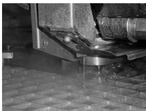
Рис. 3. Свечение, наблюдаемое между срезом калибрующей трубки и поверхностью обработки
