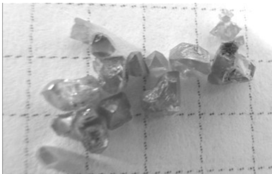
Рис. 3. Общий вид монокристаллов алмаза, выращенных в металле-растворителе Fe–Co методом переохлаждения
