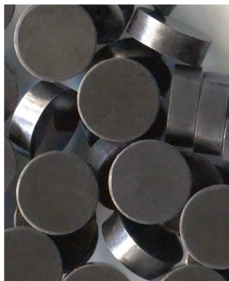
Рис. 4. Кинетика спекания КНБ (а) и внешний вид композита c BN- \text{Si}_3\text{N}_4 (режущие пластины RNMN 090300Т) (б): 1 – спекание при T = 2000 °С; 2, 3 – спекание при T = 2250 °С соответственно без добавки и с добавкой 3 % (по массе) \text{Si}_3\text{N}_4 ; 4 – расчетная плотность для беспористого композита c BN- \text{Si}_3\text{N}_4 (3 % (по массе))
