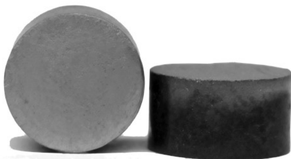
Рис. 5. Зовнішній вигляд робочих елементів різця для буріння шпурів, виготовлених з АПКМ алмаз – карбід вольфраму
