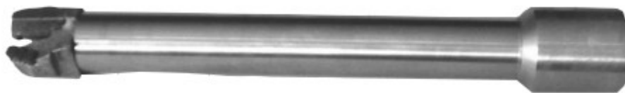
Рис. 7. Загальний вигляд різця РШ-206, встановлений на адаптері
