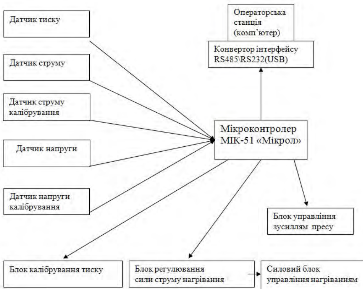
Рис. 1. Структура автоматизованої системи управління процесом спікання
