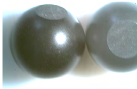
Рис. 6. Загальний вигляд алмазного композиційного матеріалу у формі кулі
