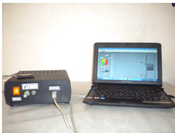
Рис. 1. Внешний вид автоматизированной системы регистрации данных тарировки
