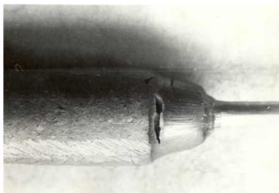
Рис. 7. Внешний вид прессостатка после экструзии никелевого образца
