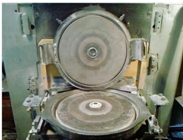
Рис. 1. Общий вид АД типа «тороид» с центральным углублением 30 мм
