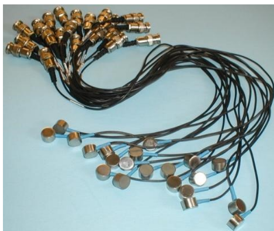
Рис. 2. Внешний вид (а) и конструкция (б) широкополосного датчика АЭ: 1 – корпус; 2, 3 – пьезоэлементы; 4 – нерабочий электрод; 5, 6 – рабочие электроды; 7, 8 – провода; 9 – тело демпфера (композит из карбида вольфрама, нитрида титана и эпоксидной смолы)
