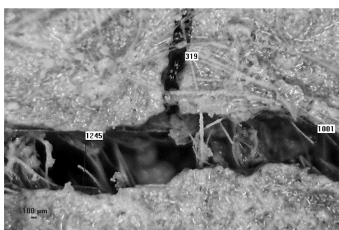
Рис. 7. Фото тріщини армованого тампонажного каменя (масштаб 30:1)
