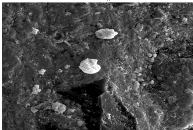
Рис. 2. Морфология поверхности износа алмазосодержащего композиционного материала после 1 минуты шлифования хрусталя: а, б – матрица Cu - 20 \text{ масс. \% Sn} ; в, г – матрица Cu - 20 \text{ масс. \% Sn} - B_4C
