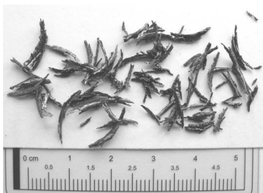
Рис. 9. Зовнішній вид стружки, що утворилась після обробки дослідним інструментом
