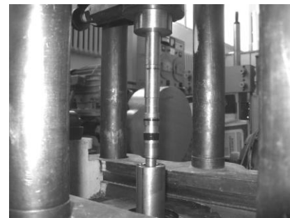
Рис. 7. Робоча зона випробувальної машини УИМ-50 із встановленим дослідним інструментом
