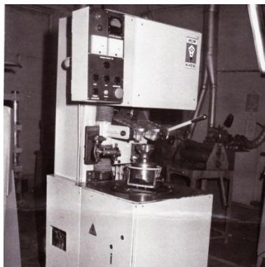
Рис. 5 Внешний вид станка, изготовленного на Опытном заводе ИСМ НАН Украины, для восстановления штыревых коронок диаметром 36–250 мм и коронок типа КНТУ
