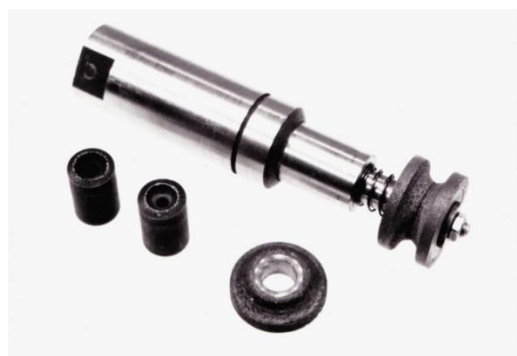
Рис. 6 Общий вид алмазного инструмента – оправки с фасонными кружками и головки для обработки штыревых коронок
