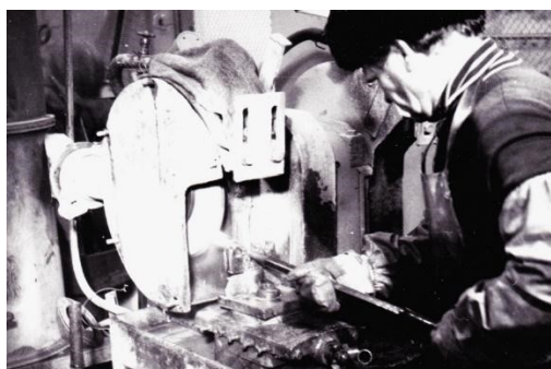
Рис. 1. Восстановление затупленных коронок вручную на точильно-шлифовальном станке ЗС-1 кругами из карбида зеленого кремния
