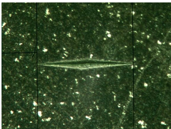
Рис. 2. Структура нанокompозита алмаз–WC, спеченного при 7,7 ГПа и 1850 °С с объемным содержанием WC 10% (длина отпечатка от индентора Кнупа при нагрузке 9,8 Н составляет 81 мкм)
