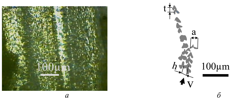
Рис. 5. Загальний вигляд: а – робочої поверхні матриці породоруйнівного елемента з «славутича» з розміром торця 3 \times 7 \text{ мм} ; б – схематичного зображення мікробибін твердого сплаву у вигляді борозенок на поверхні матриці, ( a – ширина мікробибін; h – відстань між борозенками; t – крок відколювання мікрочастинок твердого сплаву; v – вектор швидкості відколювання мікрочастинок твердого сплаву)
