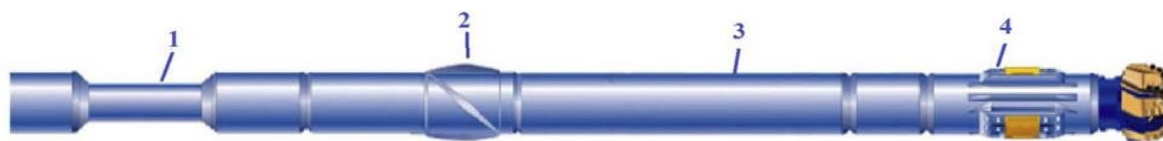
Рис. 1. Загальний вигляд (схематичний) РКС, Power Drive фірми «Schlumberger»: 1 – гнучкий патрубков; 2 – калібратор; 3 – модуль системи керування; 4 – відхиляючий модуль
