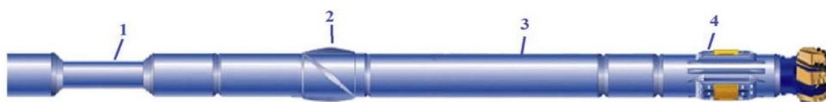
Рис. 1. Загальний вигляд (схематичний) РКС, Power Drive фірми «Schlumberger»: 1 – гнучкий патрубок; 2 – калібратор; 3 – модуль системи керування; 4 – відхиляючий модуль
