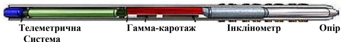
Рис. 5. Схема сучасної системи телеметрії та ГДС при бурінні
