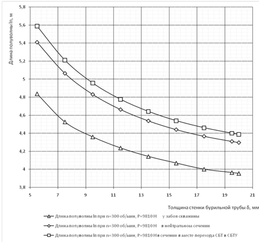
Зависимости длины полуволны в различных сечениях сжатой части буровой колонны от толщины стенки буровой трубы
