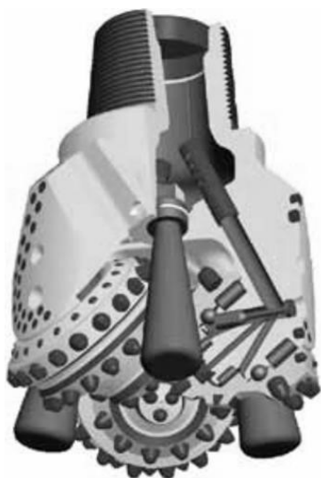
Рис. 1. Общий вид долота с системой очистки
