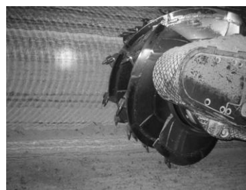
Рис. 4. Фото расположения резцов на роторе комбайна
