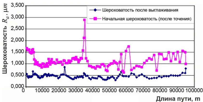
Рис. 5. Зависимость шероховатости обрабатываемой заготовки из стали 40Х от длины пути, пройденного наконечником, армированным композитом АКТМ+
