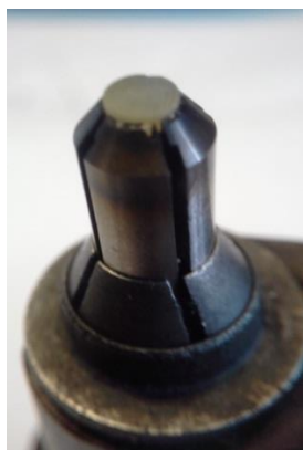
Рис. 7. Монокристалл природного алмаза, подготовленный к эксперименту
