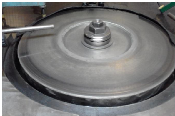
Рис. 8. Ограночный диск, шаржированный для эксперимента
