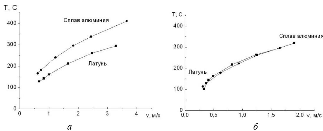
Рис. 6. График изменения температуры в зоне резания  $T$  при обработке с подачей  $S = 0,05$  мм/об (а) и  $S = 0,1$  мм/об (б) в зависимости от скорости резания  $v$
