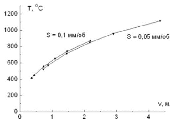
Рис. 4 График изменения температуры в зоне резания  $T$  при обработке сплава титана в зависимости от скорости резания  $v$
