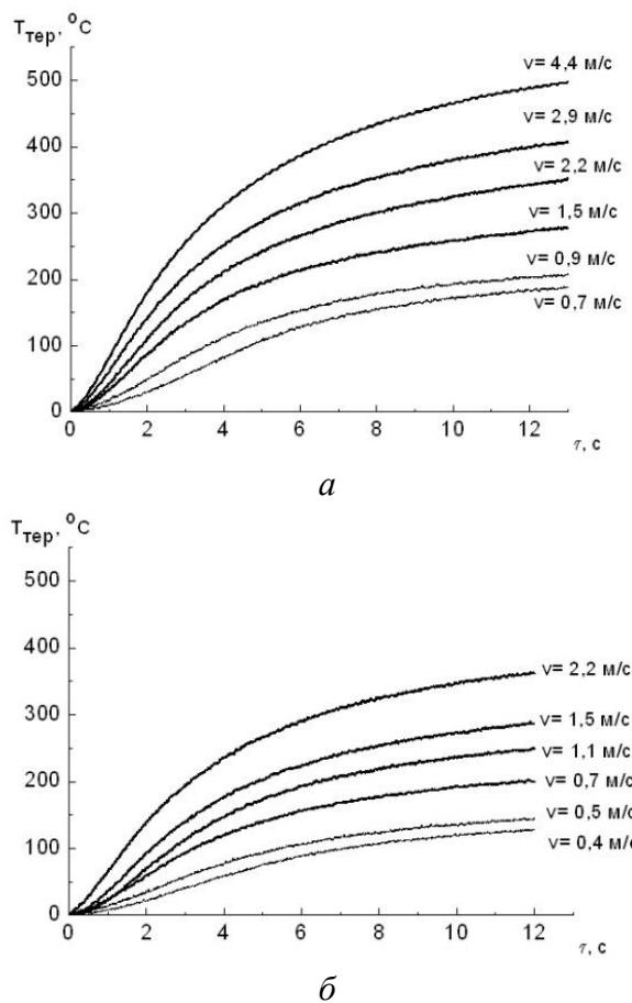
Рис. 3. Графики изменения температуры термопары  $T_{\text{тер}}$  резца в зависимости от времени обработки  $\tau$  для разных скоростей резания  $v$  при точении сплава титана с подачей  $S = 0,05 \text{ мм/об}$  (a) и  $S = 0,1 \text{ мм/об}$  (б)
