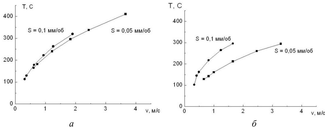
Рис. 5. График изменения температуры в зоне резания  $T$  при обработке сплава алюминия (а), латуни (б) в зависимости от скорости резания  $v$
