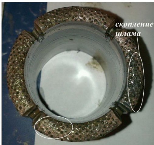
Рис. 1. Пример скопления илама на сбегавшей части сектора коронки
