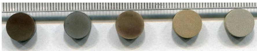
Рис. 4. Изображение образцов композита алмаз- \text{CaMg}(\text{CO}_3)_2 после отжига на воздухе при температурах 700, 800, 900, 1100 и 1200 °C (слева направо)
