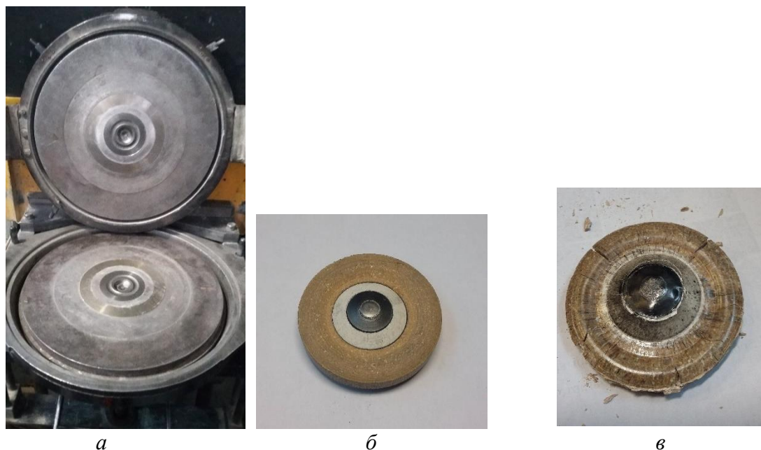
Рис. 1. АВД типа тороид с диаметром лунки 30 мм: а – блок-матрицы с твердосплавной вставкой из ВК6; б – сборка контейнера и тороидальное кольцо до сжатия и спекания; в – сборка контейнера и тороидальное кольцо после термобарического спекания
