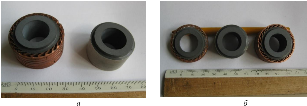
Рис. 6. Кільця об'ємних поглиначів мікрохвильового діапазону для сповільнювальної системи потужної ЛБХ імпульсного режиму різних розмірів: \varnothing 30 \times \varnothing 17 \times 20 мм (а), \varnothing 30 \times \varnothing 17 \times 7,5 мм (б)
