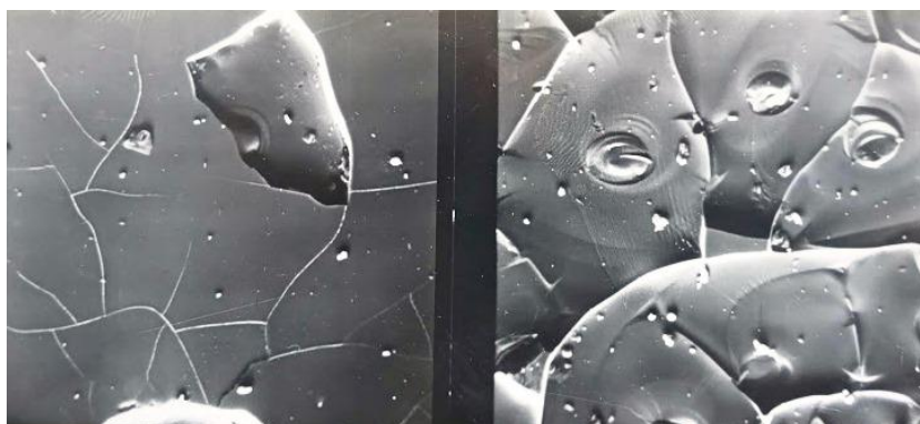
Рис. 3. Следы когезионного разрушения стекла при полировании
