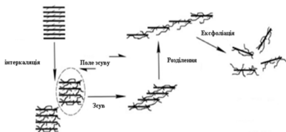
Рис. 3. Ексофліація у рідкому середовищі під дією ультразвуку
