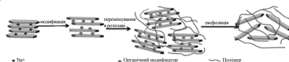
Рис. 7. Схема процесу отримання ексfolіюваного нанокомпозиту полімер/органоглина в розплаві
