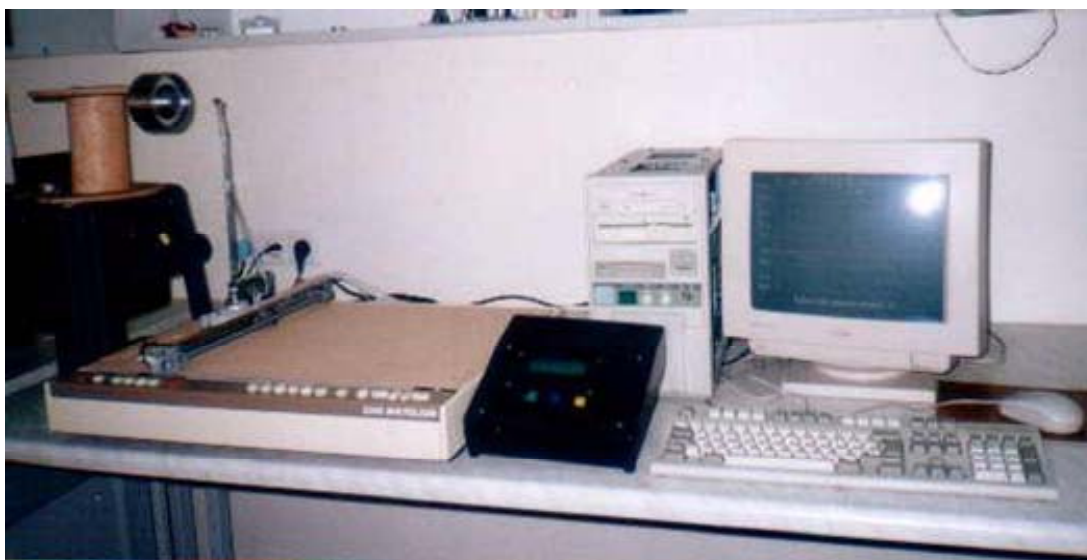
Рис. 4.5. Общий вид лабораторной измерительной установки для определения характеристик стационарных неоднородных магнитных полей.
