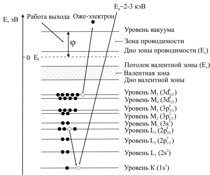
Рис. 12. Схема электронных оже-переходов KL_3M_{45} .
